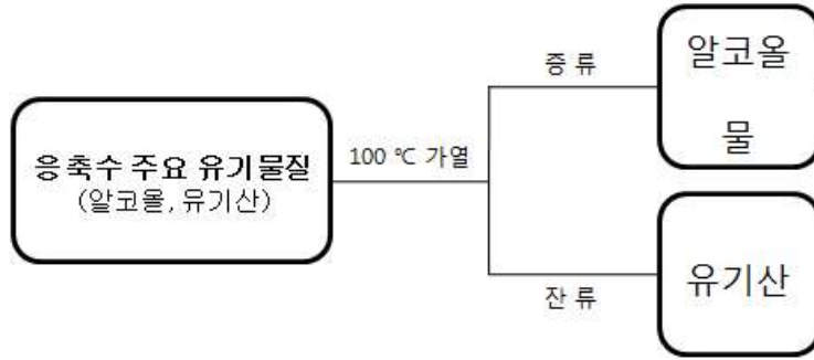
<그림 3-10> 응축수의 유기물질 분별증류 원리 및 전략
