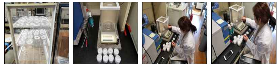
그림 11 여과지 무게 측정 과정
