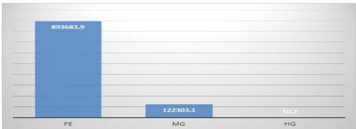
그림 36. 중금속 분석을 위한 ICP-OES용 검출 결과(단위, \mu\text{g}/\text{kg} )
