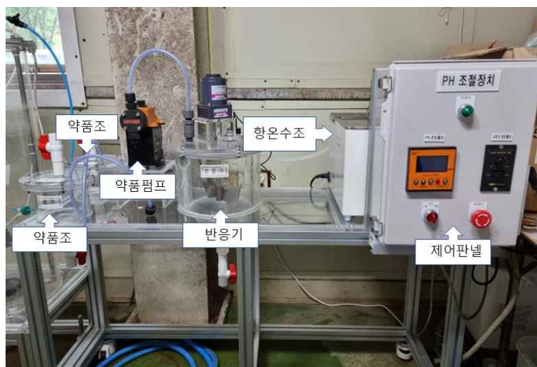
그림 16. pH조절 및 암모니아스트리핑장치 전경사진
