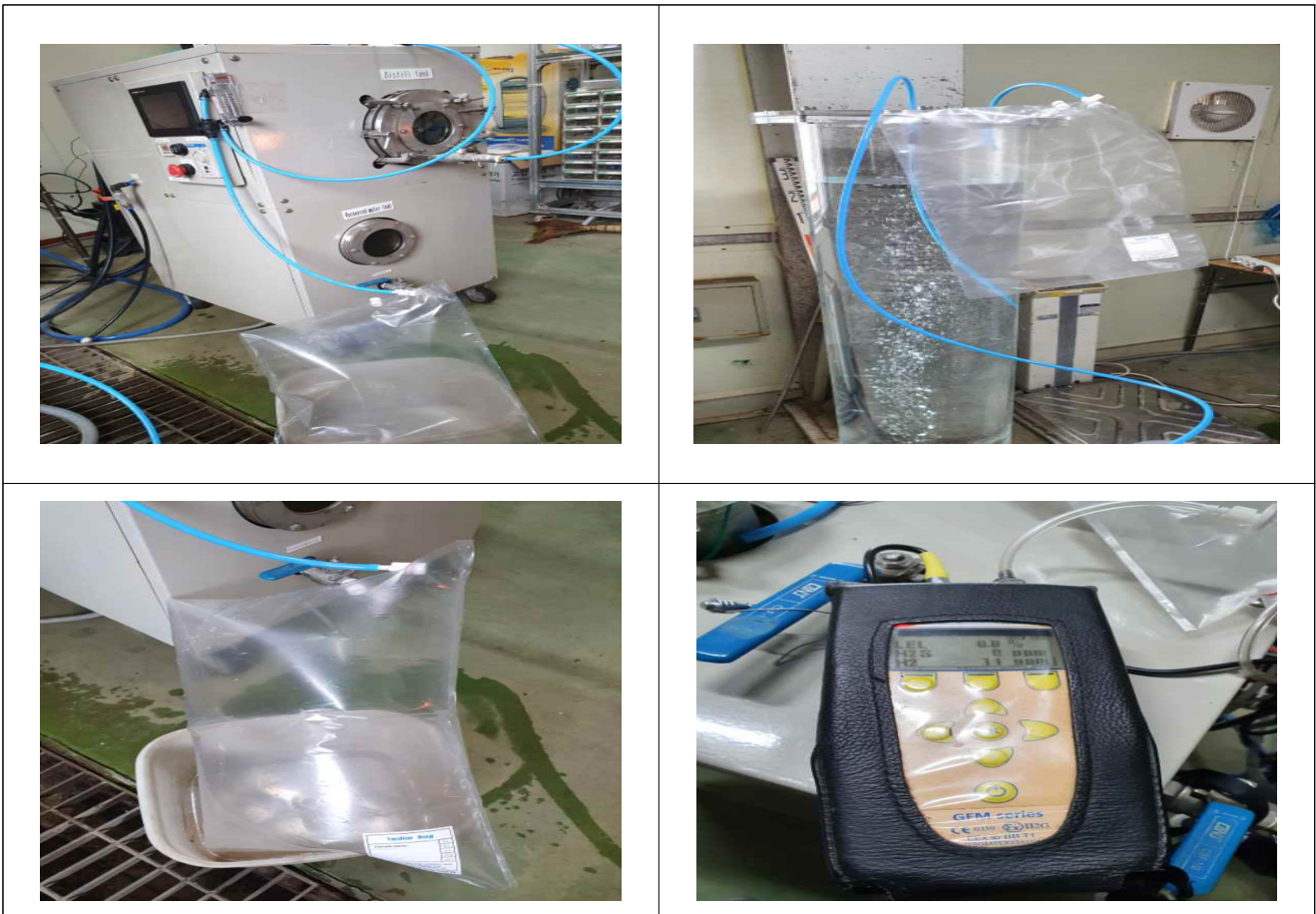
그림 77. 악취가스 포집(실험군: 반응기 외부 port 직접 채기, 대조군: 침지식반응기 처리 후 취기) 및 portable 측정기
