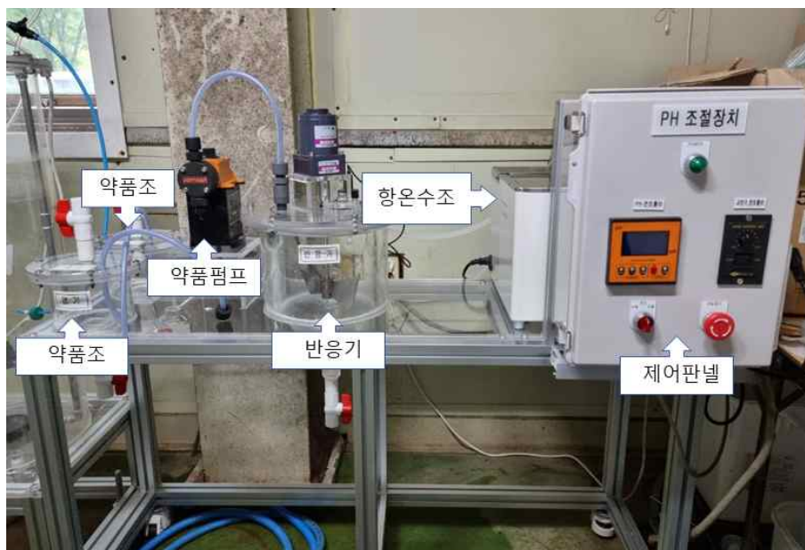
그림 72. pH조절 및 암모니아스트리핑장치 전경사진
