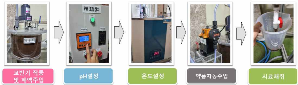
그림 17. pH조절 및 암모니아스트리핑장치 작동순서
