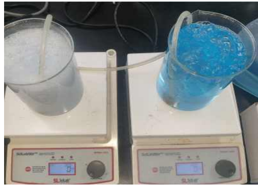
그림 15. 암모니아 stripping 실험 (Run.1(좌)/Run.2(우))
