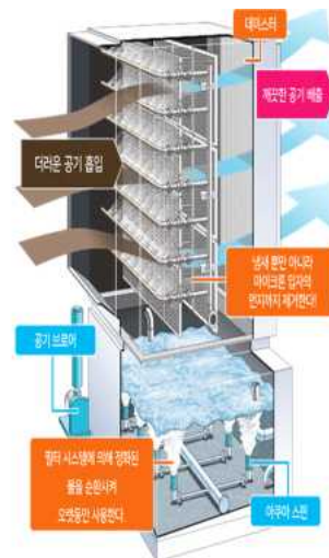
하이브리드 집진기에 장착된 특수 스테인리스 스틸 필터
