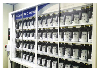
<수성도료 교반 보관시설(동파방지)>
